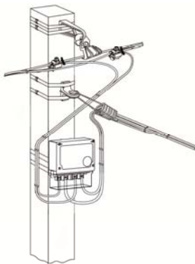
Внешний вид счетчика НЕВА СП1, установленного на опору
