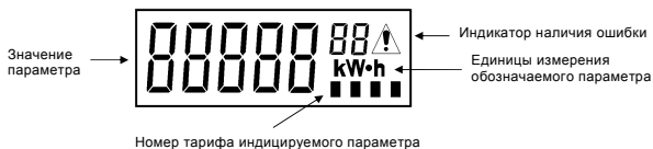
Рисунок 2.1 – Расположение информации на индикаторе
